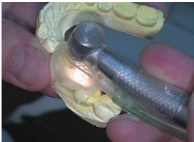
**Figure 4: fraisage d'un moulage en plâtre réalisant sous spray des effluents très opaques, ce test valide la transparence du dispositif**
